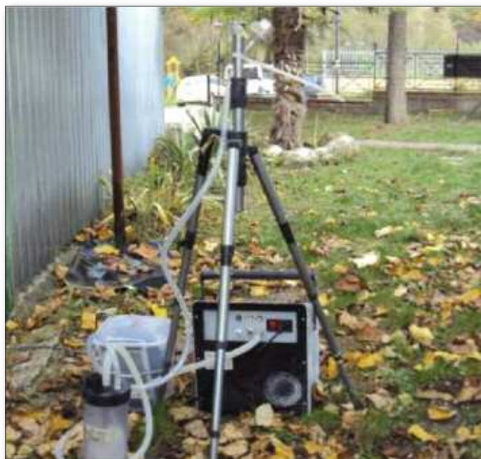
Fig. 16 - Attività di monitoraggio ambientale. Strumentazione per le misurazioni relative all'atmosfera
